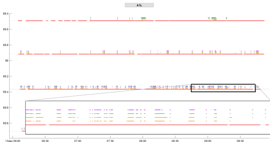
Figuur 30: Extreem voorbeeld waarin vele korte inschakelingen van FCD varianten overlappen met één lange inschakeling van MTM
